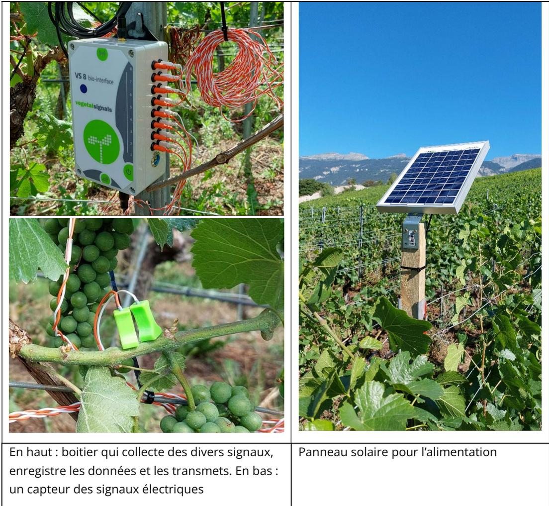
En haut : boîtier qui collecte des divers signaux, enregistre les données et les transmet. En bas : un capteur des signaux électriques
